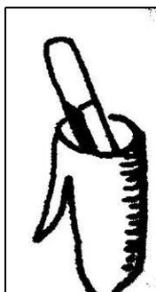
On passe la pierre d'abord dans le sens de la longueur, puis avec de petits mouvements circulaires et enfin, par de courts passages linéaires, perpendiculairement au tranchant, pour que l'affutage soit homogène. La pierre est assez douce pour ne pas entamer le métal.
