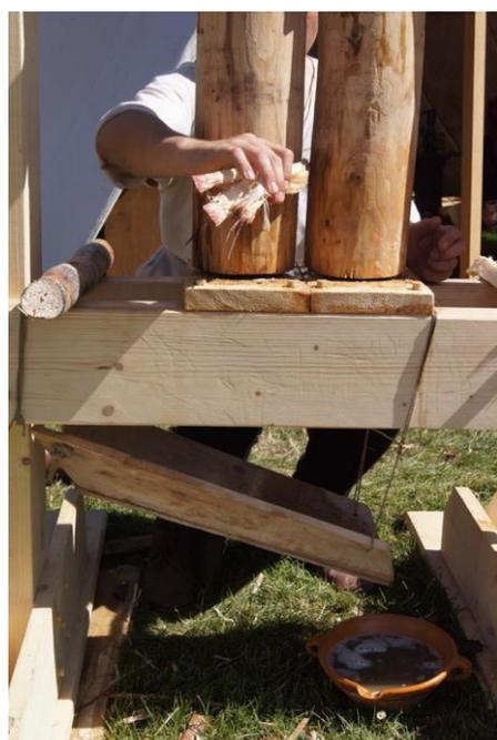
passent donc entre les deux rouleaux de bois, dont l'un est entrainé par une barre pouvant être manipulée par une ou deux personnes, et entraine également l'autre rouleau par des roues dentées. Le jus de canne s'écoule alors dans un récipient via une gouttière de bois située sous les rouleaux.
